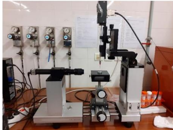
Figura 11- Equipamento utilizado para medir ângulos de contacto de líquidos sobre as superfícies a analisar.
