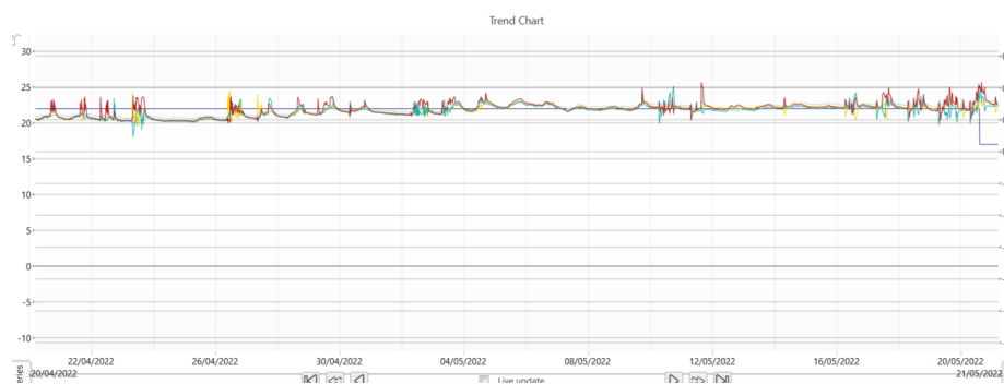
Figura 5.6: Valores da temperatura na UTA_02_03 desde o dia 20 de abril até ao dia 21 de maio. O eixo das abcissas representa os dias e o eixo das ordenadas as correspondentes temperaturas em graus Celsius [40] .
