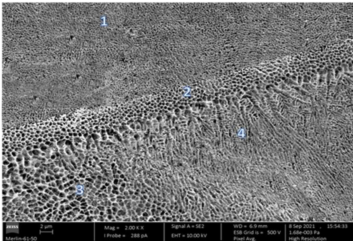
Figura 4.1. Micrografia SEM da liga de alumínio AlSi10Mg produzida por L-PBF sem tratamento térmico.
