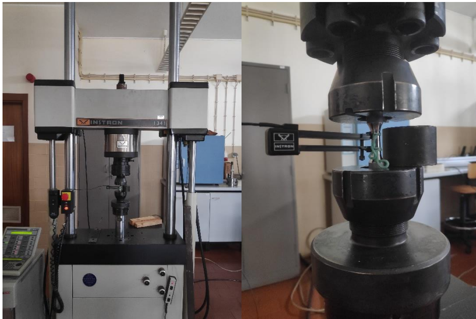
Figura 3.2. Controlo de deformação - Extensómetro Instron 2620-601
