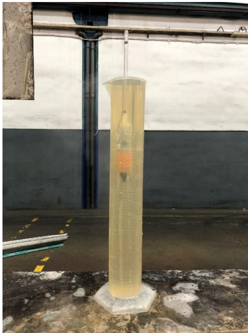
Figura 3.4-Exemplo de medição de concentração
