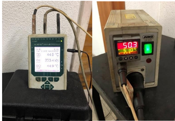
Figura 4.5-Registor e controlador da temperatura (Fapricela S.A.)
