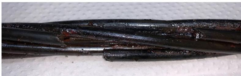
Figura 4.6-Exemplo de uma rotura do ensaio de corrosão (Fapricela S.A.)
