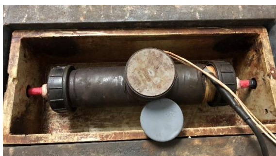
Figura 4.3-Recipiente cilíndrico do ensaio de corrosão (Fapricela S.A.)
