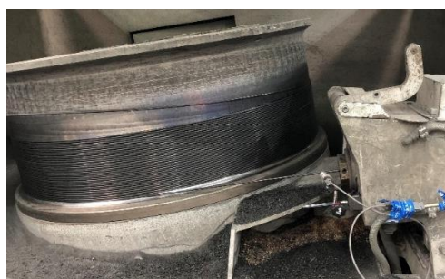
Figura 4.2-Posicionamento do pirómetro-vista de frente (Fapricela S.A.)
