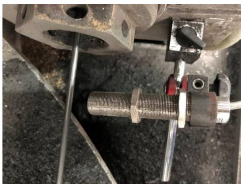
Figura 4.1-Posicionamento do pirómetro-vista de cima (Fapricela S.A.)
