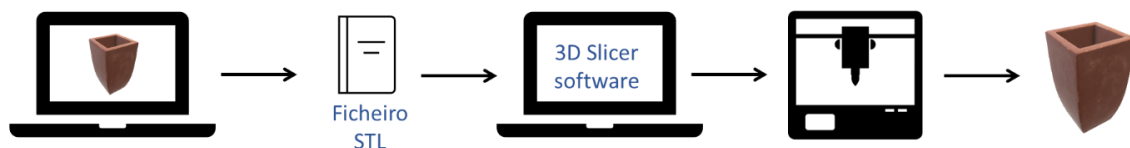
Figura 1.1. Esquema do processo de criação de uma peça 3D por FA.
