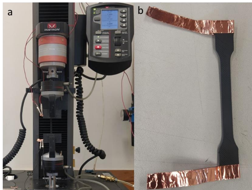
Figura 2.6. a) Equipamento de ensaios de tração e medição de resistência elétrica; b) Provete com fita de cobre nas extremidades.
