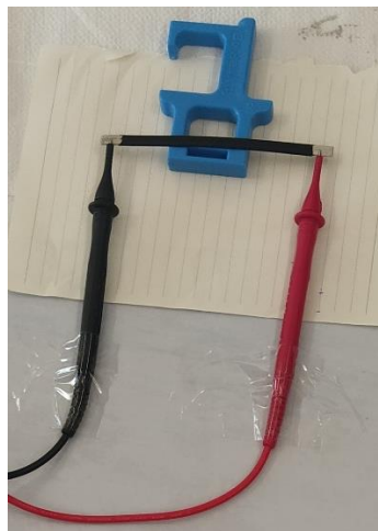
Figura 2.3. Medição de resistência elétrica após processamento do material.
