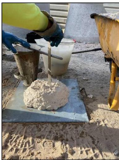
Figura 5.14 – Execução do ensaio SLUMP ao betão.
