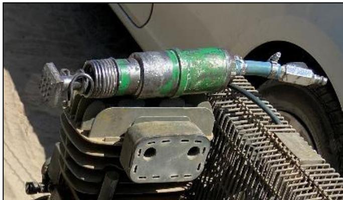
Figura 5.3 - Bujarda para acoplamento a equipamento de ar-comprimido.
