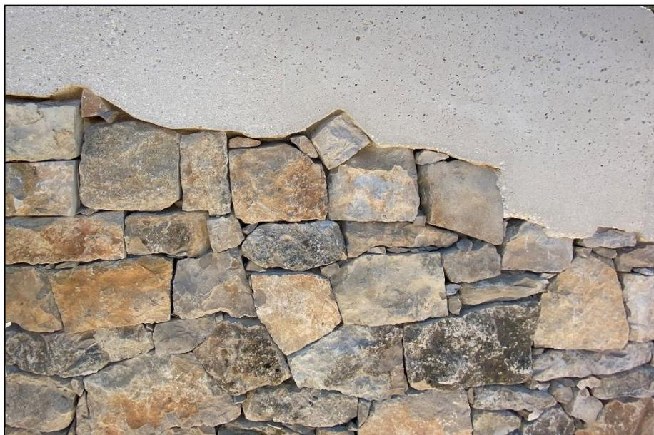
Figura 5.2 – Amostra final (face de remate de betão com pedra).
