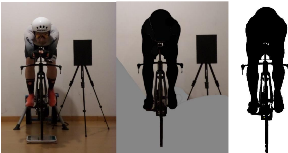
Figura 5.5. (a) Imagem original do conjunto ciclista + bicicleta; (b) Imagem após processamento no programa Adobe Photoshop 2020 ; (c) Imagem final no programa ImageJ .
