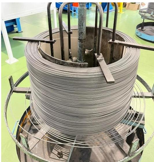
**Figura 8: Rolo de aço trefilado**
