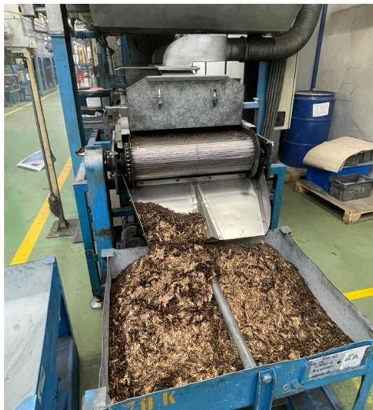
**Figura 17: Descarga de peças soltas após RVC**
