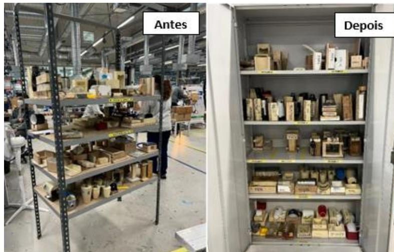
**Figura 4.6.** Exemplo de Aplicação de 5S no Armazenamento de Moldes.
