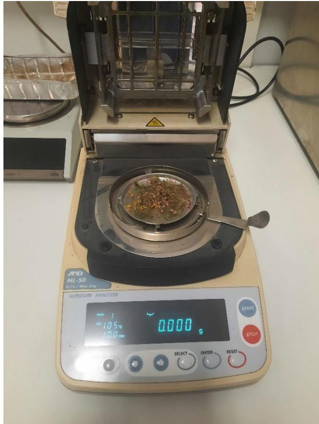
**Figura 3.5.** Balança de medida de humidade AnD ML-50.
