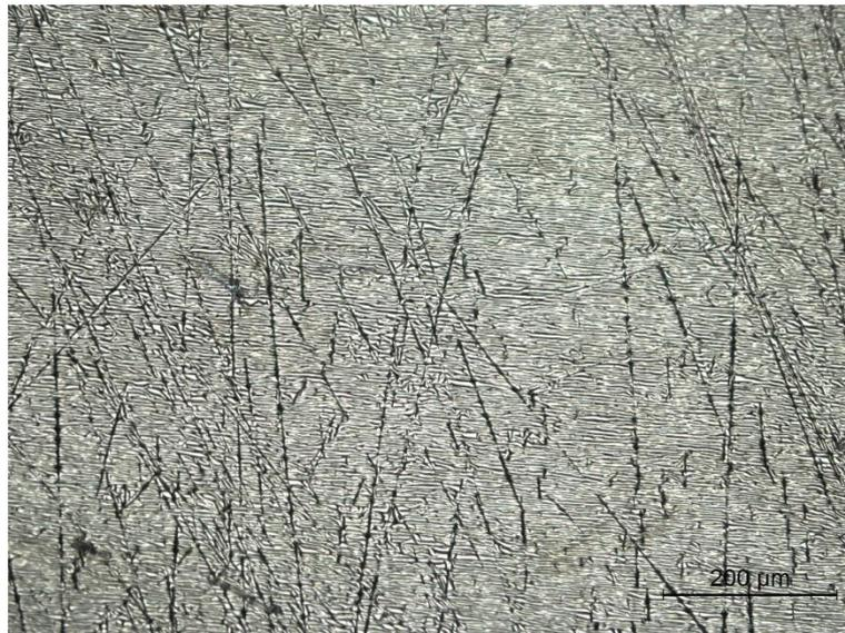
**Figura C. 8.** Análise microscópica da deposição com 5min de limpeza do substrato PC refletor com amplificação de 10x.
