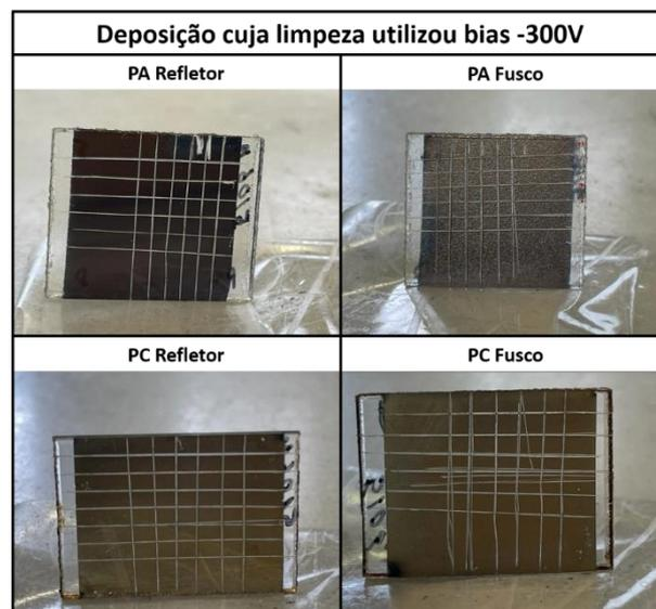
**Figura 5.22.** Teste de adesão realizado às amostras poliméricas na deposição cuja limpeza utilizou *bias* = -300V.
