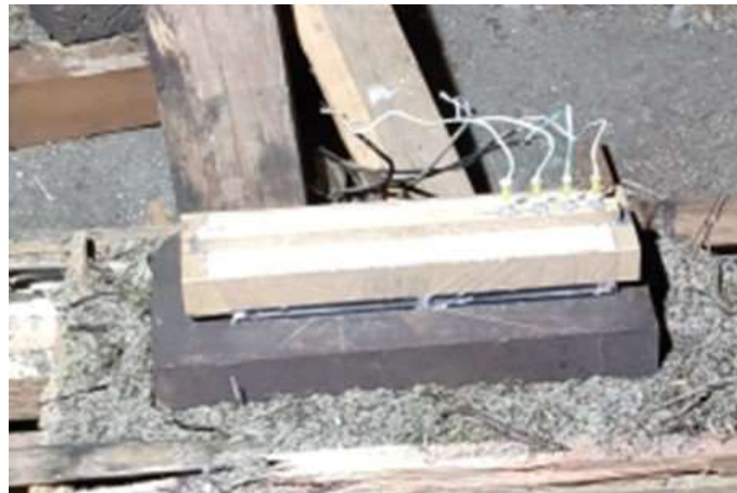
Figura 3.2. Montagem do ensaio experimental EW63 no interior da câmara de explosão.
