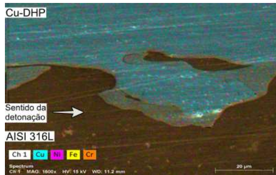
Figura 4.15. Secção da amostra EW66L1 submetida a análise EDS
