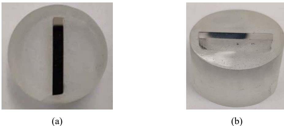
Figura 3.6. Amostra de EW63MBB envolvida em resina (aspeto final): (a) vista de topo; (b) vista de perfil.
