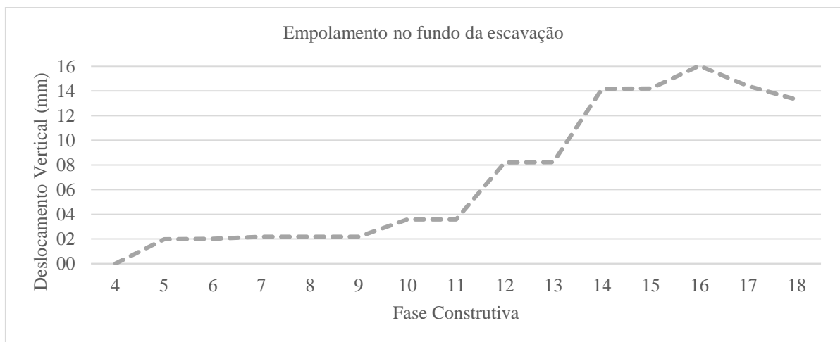
Figura 48 - Empolamento do centro do fundo da escavação.
