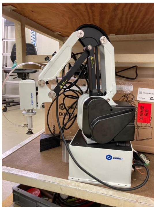
Figura II. 2. Robot colaborativo – (DOBOT MG400, s.d.)
