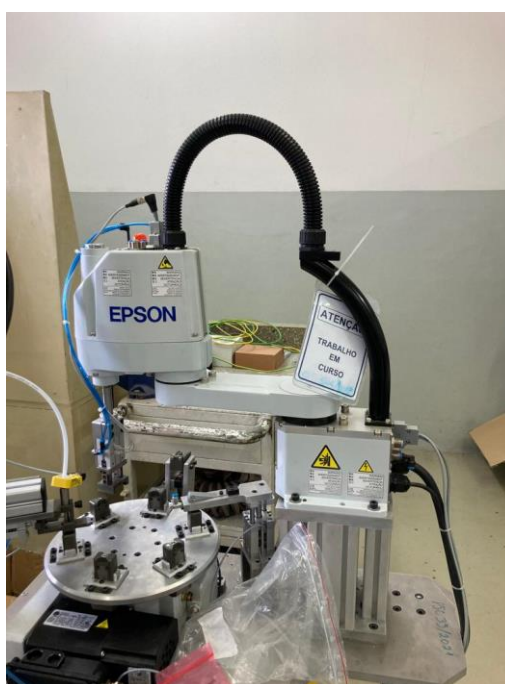
Figura III. 3. Robot não colaborativo, (EPSON)
