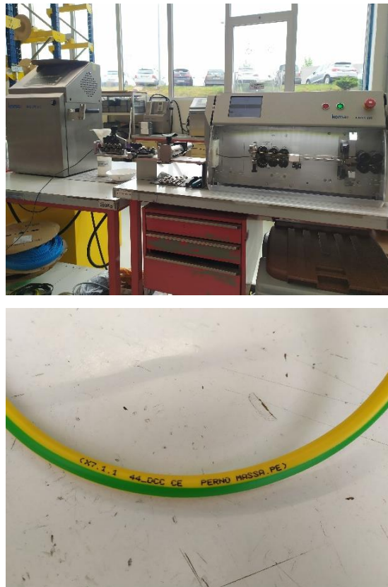
Figura 3.5 – Equipamento Komax (primeira imagem) e cabo com marcação (segunda imagem)
