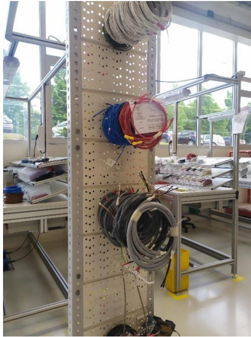
Figura 3.9 – Cabos finalizados na secção cravação
