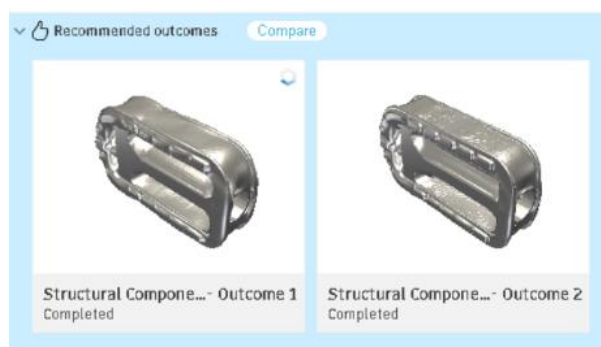
Figura 2.12. Outcomes gerados pelo software de desenho generativo para o componente 2.
