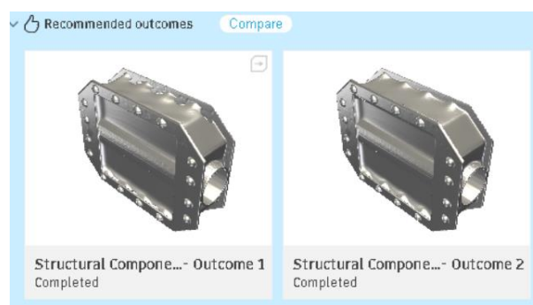
Figura 2.10. Outcomes gerados pelo software de desenho generativo para o componente 1.
