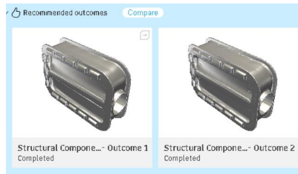
Figura 2.14. Outcomes gerados pelo software de desenho generativo para o componente 3.
