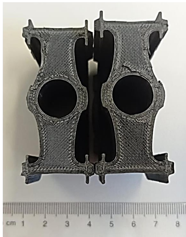
Figura 3.8. Fotografia da secção transversal do pedal 4, após ensaio de impacto, tirada pelo modelo Redmi 9 da Xiaomi.
