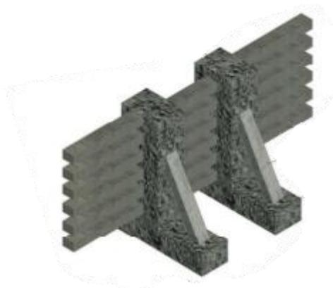
Figura 6.9 - Reaplicação de travessas monobloco em muros de suporte (Igneia et al., 2013)
