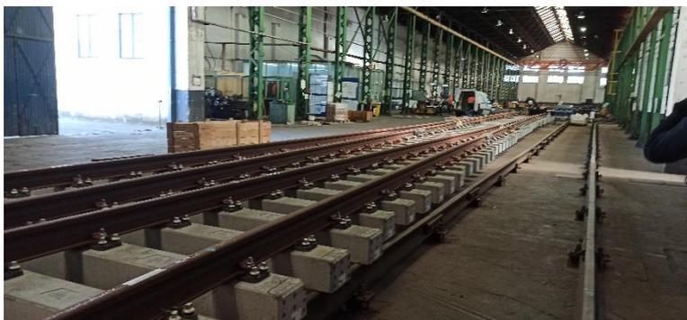
Figura 4.3 - Montagem de AMV nas instalações da Futrifer
