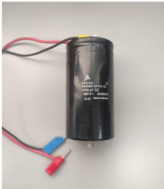
Figura B.10 Condensador utilizado à entrada e saída do conversor DAB.
