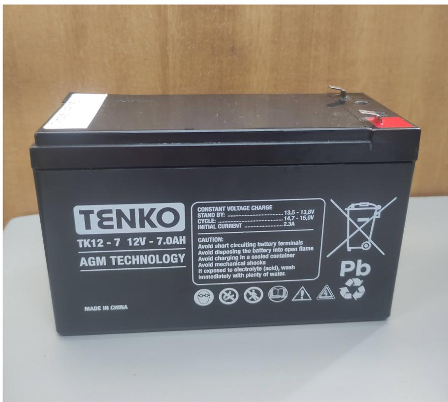
Figura B.12 Bateria utilizada no conversor DAB.
