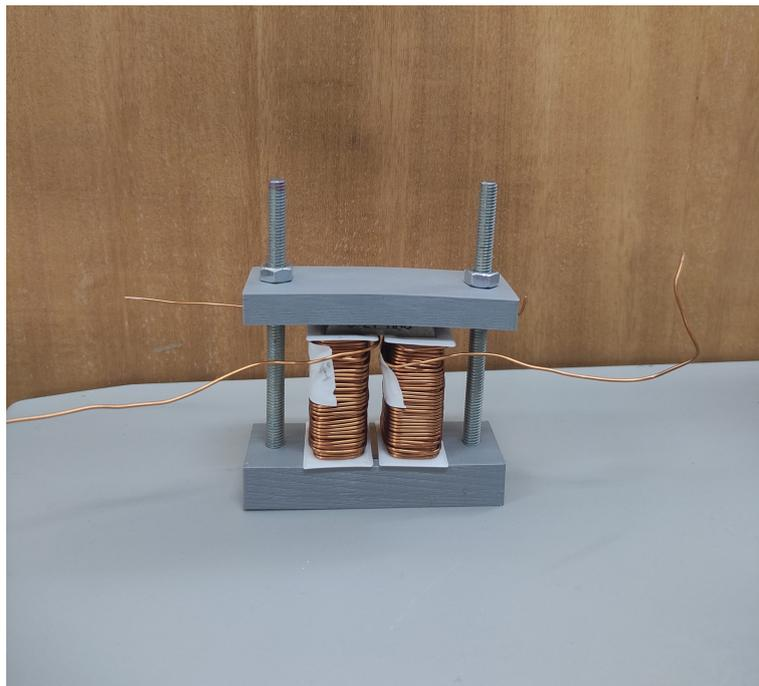
Figura B.2 Transformador de alta frequência construído em laboratório.
