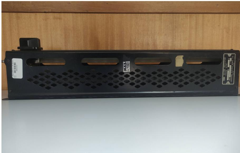
Figura B.11 Carga resistiva utilizada no protótipo experimental.
