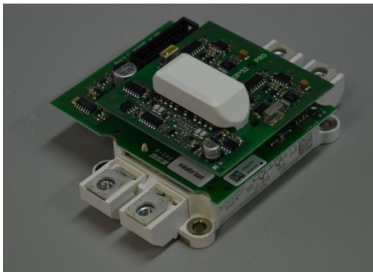
Figura B.4 Módulo de IGBT's conectado à placa de adaptação e *Driver*.
