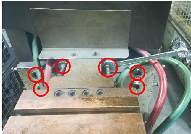
Figura A.8. Parafusos de ajuste de altura da máquina SL223.
