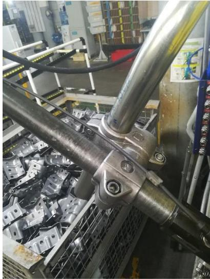
**Figura A.10.** Duas de três articulações de uma lança de alimentador de porcas.
