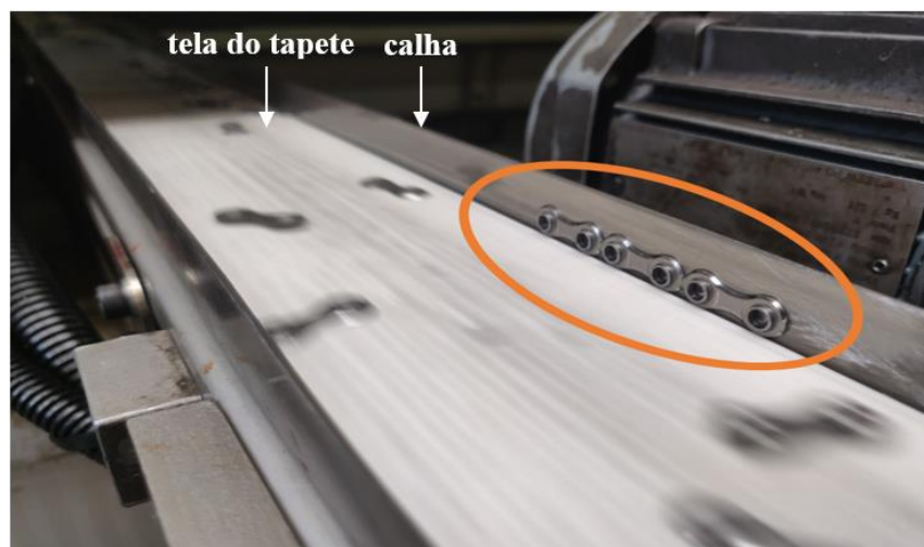
Figura 5.5. Fenómeno das placas que causam avaria no tapete de saída das peças.
