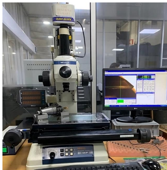
Figura 3.5. Microscópio e acessórios usados na medição de defeitos e captação de imagem
