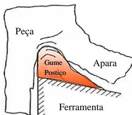
Figura 2.15. Representação formação gume postiço em ferramenta de corte (Klocke, 2011)
