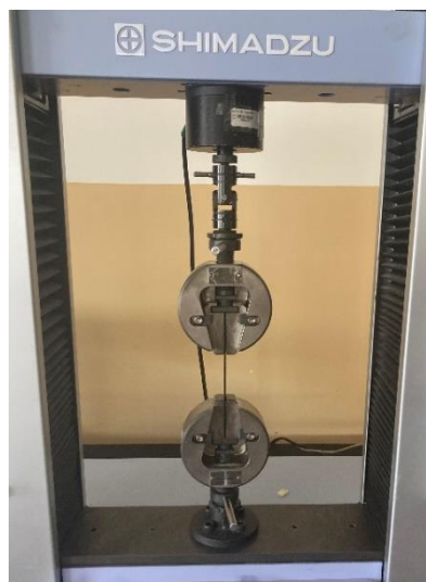
Figura 2.2. Equipamento utilizado para realizar o ensaio de tração.
