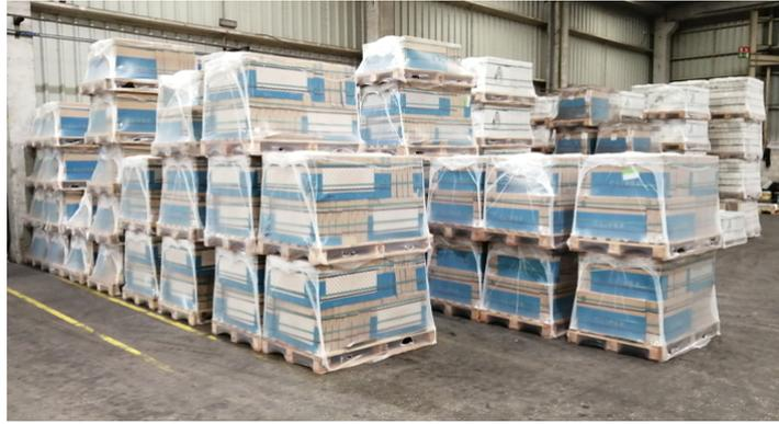
Figura 2.35.: Paletes plastificadas para seguir para o armazém de produto acabado e posteriormente seguir para expedição para o cliente.
