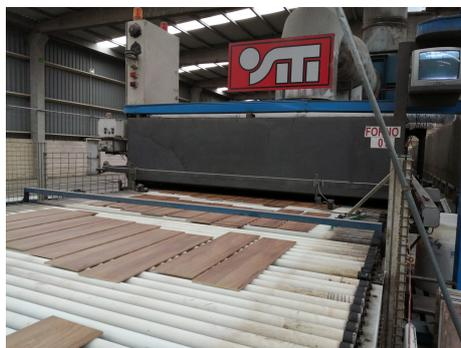
Figura 2.28.: Peças cerâmicas finais, após cozedura, que vão seguir até às vagonas para serem armazenadas. Após o armazenamento, serão transportadas por veículos automaticamente guiados até à etapa de escolha.
