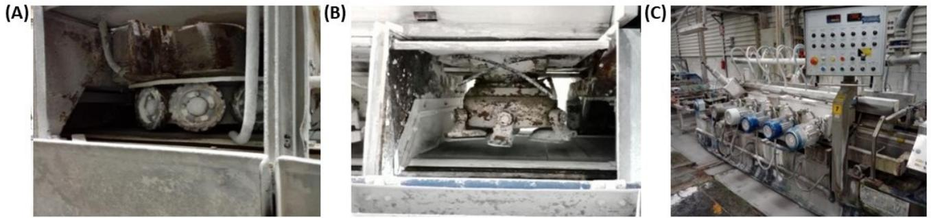
Figura 2.36.: Corte e retificação do material para um melhor acabamento do produto. O processo de polimento é usado com o objetivo de melhorar as características estéticas da peça e os procedimentos principais que ocorrem são o (A) desgaste superficial para nivelar a peça; e, seguidamente, o polimento em si com recurso a (B) grupos de mós. A retificação permite o acabamento das partes laterais da peça, sendo executada por uma (C) retificadora, instalada na secção de corte na CLiPER.
