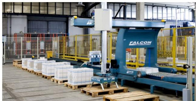
Figura 2.34.: Processo de paletização na CLiPER, após correto embalagem.
