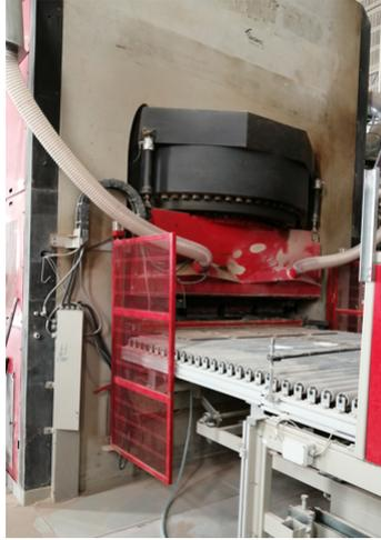
Figura 2.9.: Prensa existente nas instalações da CLiPER onde ocorre o processo de conformação das peças cerâmicas que inclui a produção de compactos com o formato e as dimensões desejadas e, também, a produção de compactos com máxima densidade e uniformidade.
