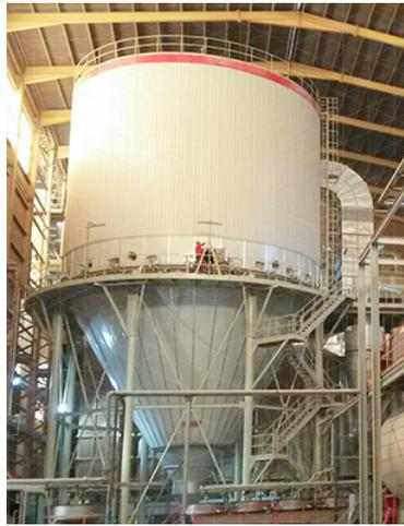
Figura 2.5.: Representação de um atomizador - câmara aquecida onde no seu interior ocorre a pulverização da suspensão (barbotina).
