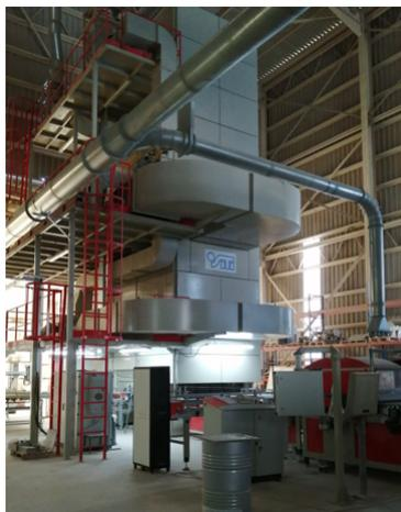
Figura 2.14.: Secador vertical contínuo existente nas instalações da CLiPER, por onde circula ar quente entre as peças cerâmicas a uma determinada temperatura e velocidade, possibilitando a remoção de quase toda a humidade que ainda restou do processo anterior.
