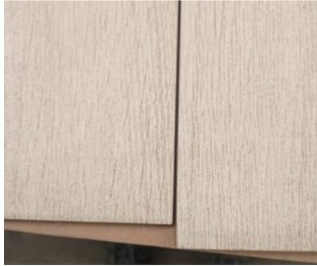
Figura 2.13.: Exemplo de um defeito relacionado com a geometria na peça cerâmica obtido por uma falha no processo de preenchimento dos alvéolos dos moldes de prensagem.
