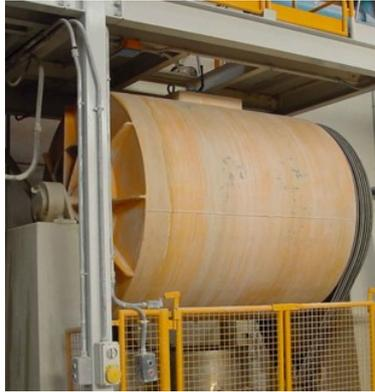
Figura 2.19.: Moinho de bolas descontínuo existente na secção de preparação de vidros que tem como finalidade a moagem dos vidros.
