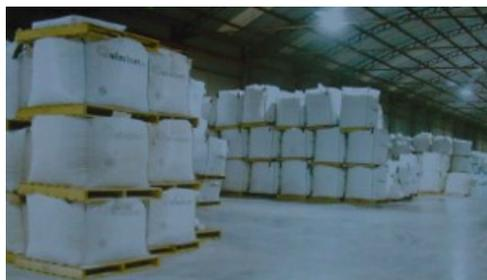
Figura 2.18.: Sacos de acondicionamento (*big bags*) contendo engobes e vidros na unidade industrial.
