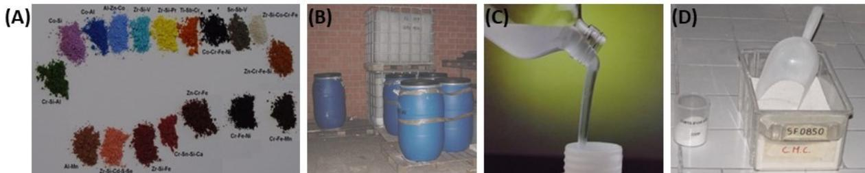
Figura 2.17.: Matérias-primas frequentemente adicionadas aos vidrados: (A) corantes; (B) desfloculantes; (C) lubrificantes; (D) ligantes - carboximetilcelulose, CMC.
