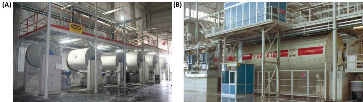
Figura 2.3.: Ilustração dos dois tipos de moinhos utilizados para a moagem do pó, ambos constituídos por aço reforçado: (A) moinhos descontínuos cilíndricos; (B) moinho contínuo cilíndrico.
