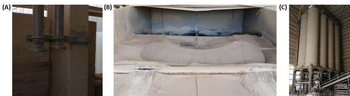
Figura 2.7.: O pó atomizado chega às instalações da unidade industrial por meio de camiões dos fornecedores e, conforme a sua tipologia, é descarregado de forma diferente a fim de evitar possíveis contaminações: (A) o pó de monoporosa é bombeado por propulsor do camião para os silos; e (B) o pó de porcelânico é descarregado numa tremonha e é, seguidamente, transportado por telas para silos de armazenamentos. Ambos os tipos de pó são armazenados em (C) silos.
