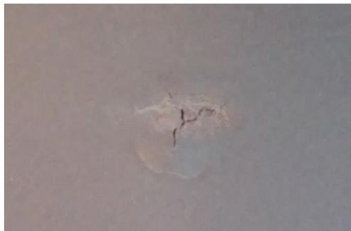
Figura 2.12.: Ilustração de um defeito possível de ser originado no processo de prensagem: folhado na peça cerâmica. Este defeito surge quando as duas fases de prensagem não são devidamente separadas por um tempo de desaeração, evitando que o ar migre do interior da peça até às interfaces com o molde.
