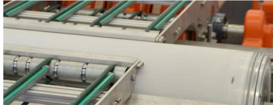
Figura 2.24.: Equipamento para aplicação do engobe de tardez - mistura refratária que tem como principal função evitar a aderência das peças aos rolos no forno, evitando, assim, desalinhamentos na carga.
