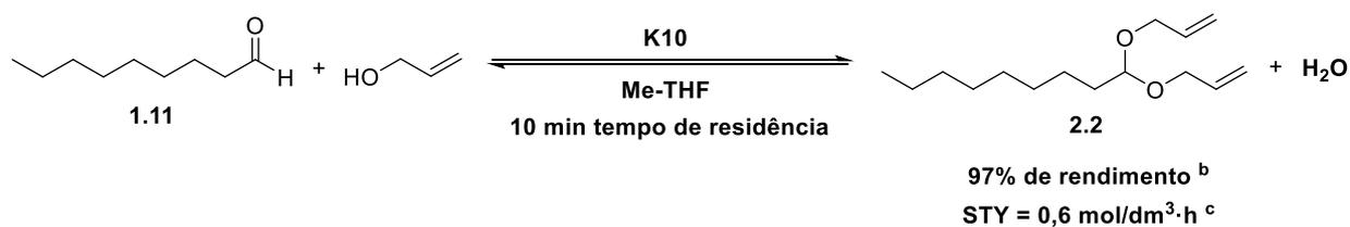
**Figura 2.11** – Reação de acetalização do nonanal **1.11** em sistemas de fluxo contínuo sob as condições ótimas.
