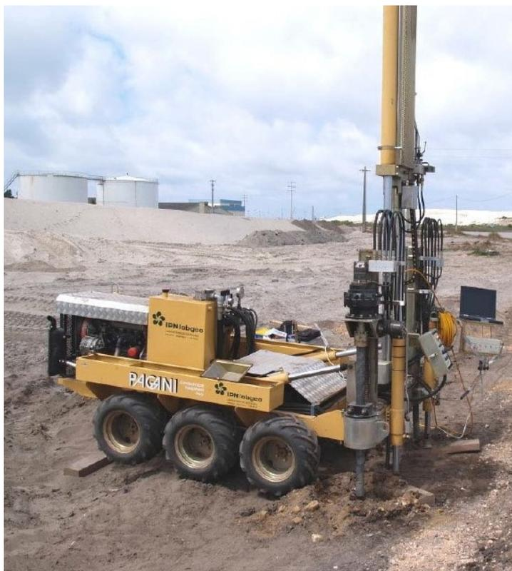
**Figura 6** – Exemplo de execução de um ensaio CPTu.
