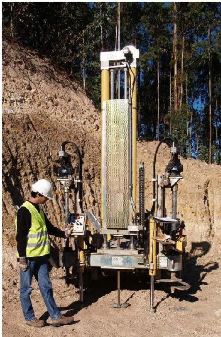
**Figura 5** – Exemplo de execução de um ensaio PDSP.
