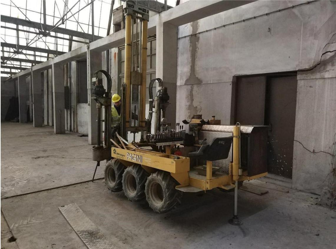
**Figura 15** – Execução do ensaio de Penetração Dinâmica Super Pesada, PDSP 4, com equipamento da marca Pagani, modelo TG 73 – 200.
