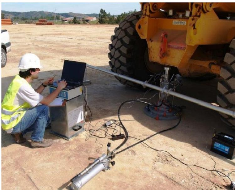
**Figura 4** – Exemplo de execução de um ensaio de carga em placa.
