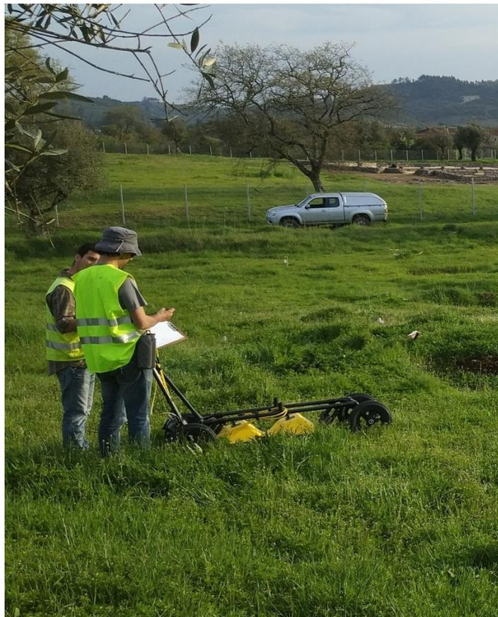
**Figura 8** – Exemplo de execução de um ensaio com o equipamento GPR.
