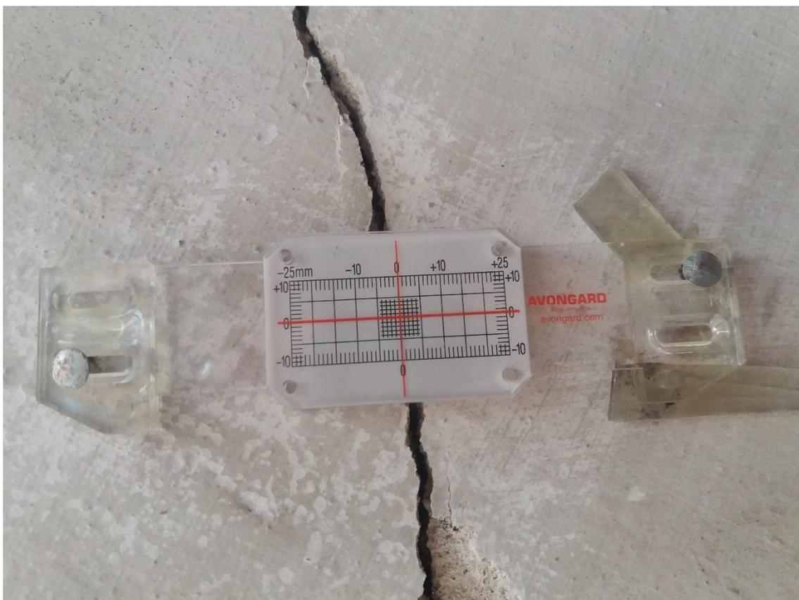
Figura 20 - Exemplo de fissurômetro N°2, após instalação.
