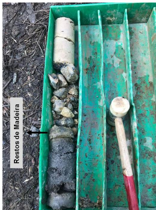
**Figura 16.** Caixa de Sondagem referente a S8, dos 4,5m aos 6m.
