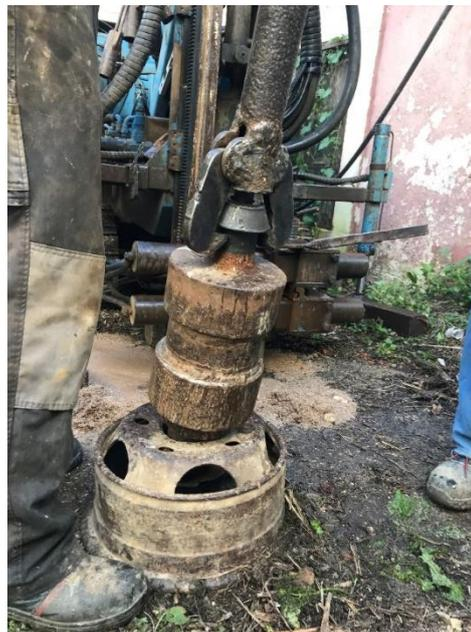
**Figura 9.** Equipamento utilizados na realização dos ensaios SPT.
