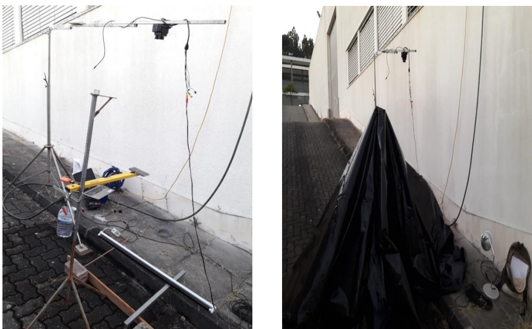
Figura 4.4 - Instalação utilizada para a aplicação dos traçadores, situada no parque de estacionamento do DEC.
