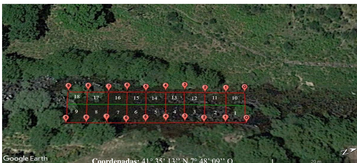
Figura 4.15 – Vista satélite do troço 1, no rio Beça. Este troço, com 45 m de comprimento, foi dividido em 18 subsecções. O 1º voo de UAS/drone captou desde a subsecção 1 até à 9, enquanto o 2º voo captou desde a 10 até à 18 (Google Earth Pro).
