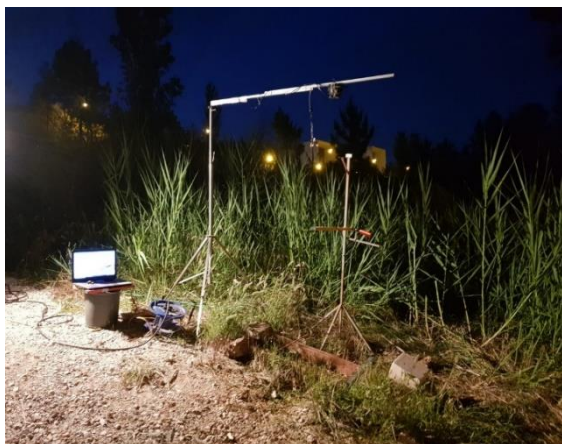
Figura 4.7 - Instalação utilizada para a aplicação dos traçadores no Pólo 2, em solos cuja superfície é constituída por vegetação.
