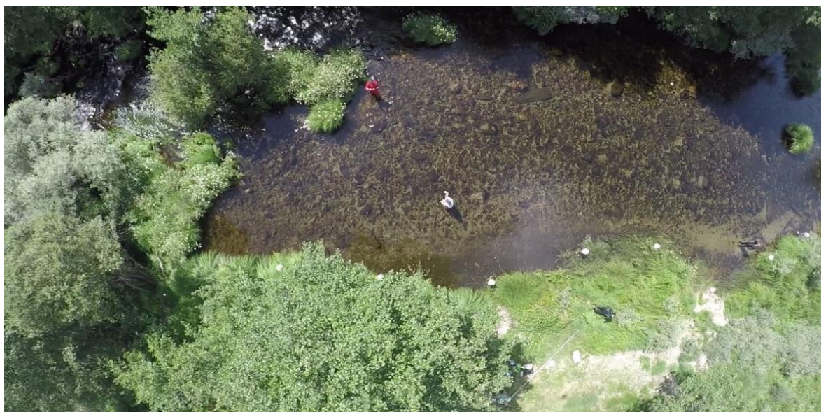
Figura 4.16 - Vista aérea do troço 1, no rio Beça, captada pelo UAS/drone, onde foram aplicados os traçadores flutuantes biodegradáveis. Os marcadores brancos de referência nas margens distam 5 m entre si.
