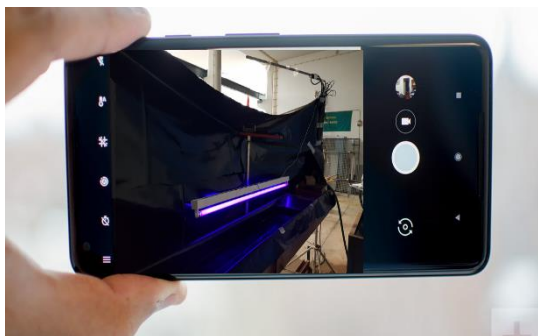
Figura 3.1 - Câmara ótica (modelo: Samsung S8), utilizada nas atividades experimentais em laboratório e no campo, para determinar as velocidades dos traçadores coloridos e fluorescentes.
