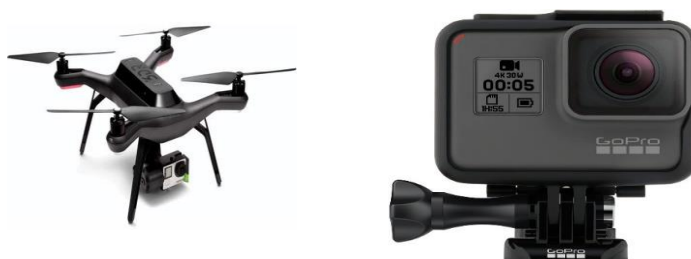
Figura 3.3 - Aeronave não tripulada (UAS/drone) (modelo: 3DR Drone Solo) (à esquerda) e câmara (modelo: GoPro – Hero 5 Black) (à direita), utilizados nas atividades experimentais no rio Beça, para determinar as velocidades dos traçadores flutuantes biodegradáveis.
