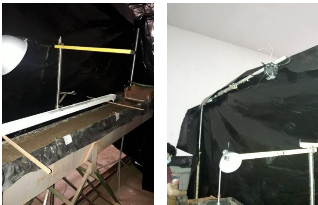
Figura 4.2 - Posicionamento da câmara ótica (Samsung S8) (figura à esquerda) e da câmara de infravermelhos (FLIR Duo Pro R) (figura à direita), situadas a 0.65 m e 1.50 m respetivamente, acima da superfície do solo do canal.
