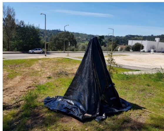
Figura 4.8 – Estrutura constituída por um plástico preto utilizada para facilitar a deteção do traçador fluorescente durante o dia, em solos cuja superfície é constituída por vegetação.
