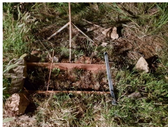
Figura 4.9 - Vegetação utilizada para aplicação dos traçadores (á esquerda) e área de medição da instalação utilizada no Pólo 2 (á direita). As dimensões da área de medição são 0.3 m × 0.55 m.
