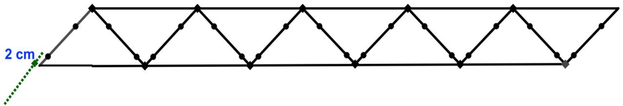
Figura 97 - Marcação dos pontos, nos lados, dos triângulos inscritos no paralelogramo, todas as partes
