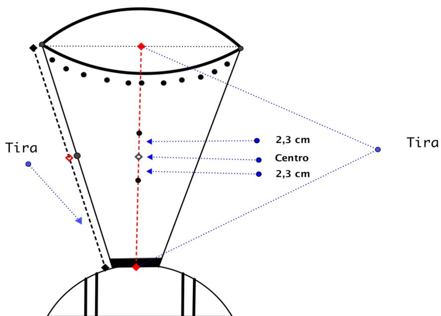
Figura 110 - Determinação do comprimento da tira vertical a partir do centro
