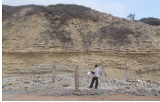
Fig. V.6 – Queda de blocos com blocometria inferior na classe < 10 \times 10^3 \text{ cm}^3 , na praia da Jomba.
