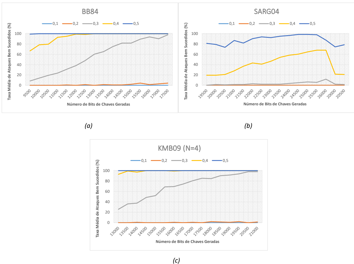
Figura 36: Taxa média de ataques PNS bem-sucedidos, para vários valores de \mu , para os protocolos (a)BB84, (b)SARG04 e (c)KMB09(N=4), em função do número de bits de cada chave gerada.
