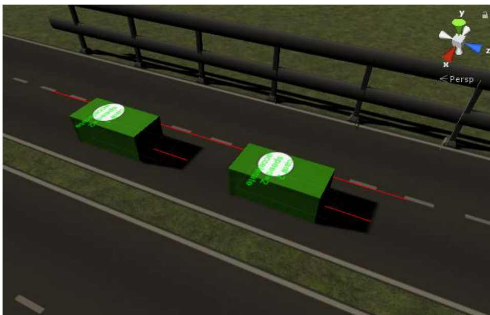
شکل ۵-۲- ارسال اشعه به منظور بررسی سبقت
