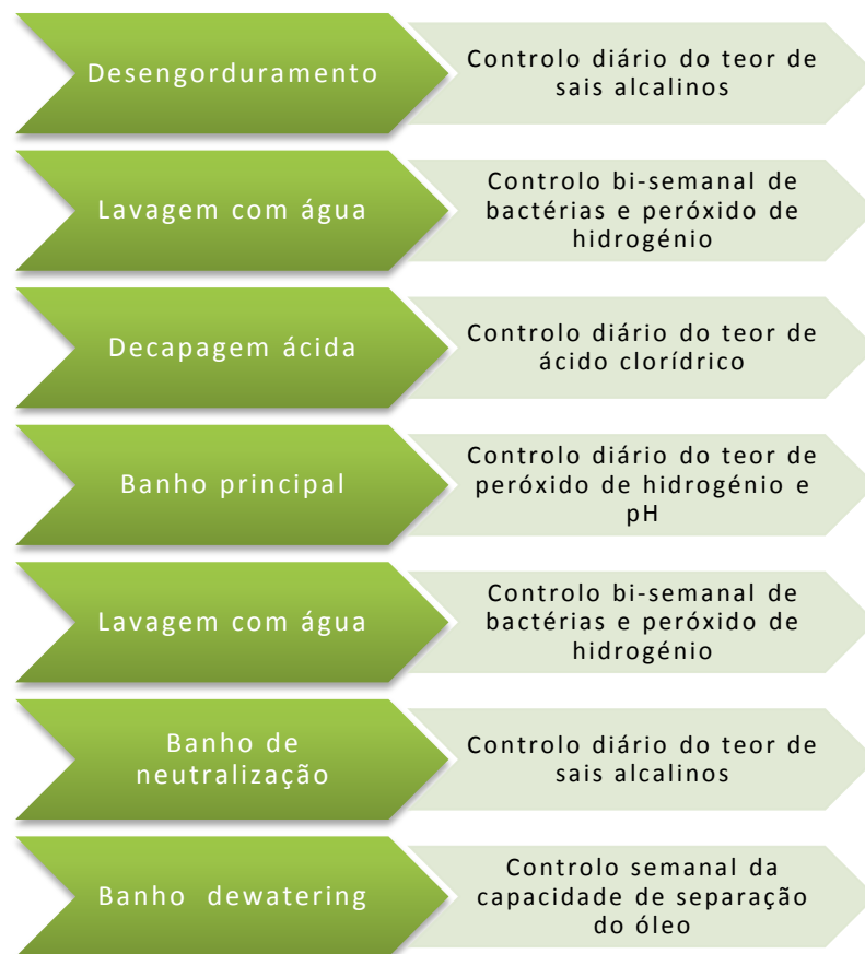
Figura 9. Controlos efectuados pelo laboratório de qualidade aos banhos da área de tratamento químico.
