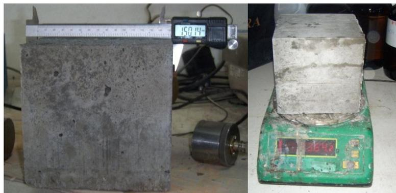
Figura 3.15 - Determinação das medidas dos provetes cúbicos e seus pesos
