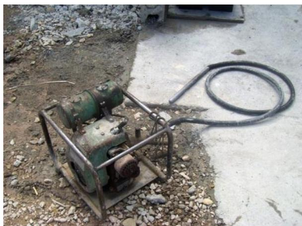
**Figura 3.5 - Agulha vibratória utilizada na vibração dos provetes**
