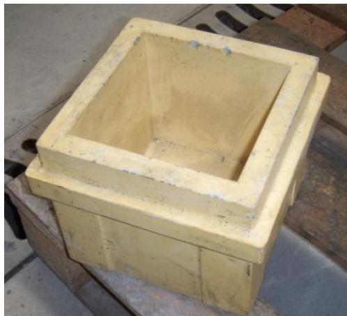
**Figura 3.4 - Provetes cúbicos utilizados na campanha experimental**
