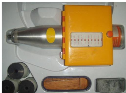
Figura 3.11 - Esclerómetro utilizado na campanha experimental
