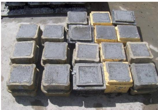
**Figura 3.6 - Provetes executados em cada betonagem**
